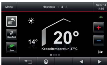
Regelung Vitotronic 200 mit Farb-Touch-Display (in Verbindung mit Gas-Brennwert-Wandgerät Vitodens 300-W)
